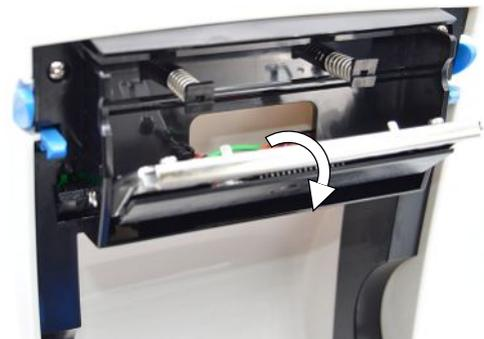
4. Lösen Sie den Druckkopfanschluss (Pos. a) und entfernen Sie die Druckkopfschrauben.
