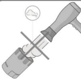
Der korrekte Betrieb der Turbine ist nur dann gewährleistet, wenn sie „sauber“ und frei von Fremdkörpern ist, die ihre Bewegung stören. Vorhandener Staub oder Fremdkörper (wie Haare oder Auswurf usw.) können die beweglichen Teile der Turbine bremsen oder blockieren und die Genauigkeit des Ergebnisses beeinträchtigen oder die Turbine beschädigen. Prüfen Sie die Sauberkeit der Turbine nach jeder Verwendung.
