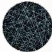
HMT 110.000 Fasern/cm 2 ø 0,4 Mikrometer
