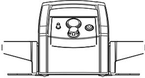
Para facilitar su uso, el porta-recipiente puede desmontarse y volverse a montar en el lado (DER. o IZQ.) que considere más adecuado.
