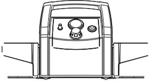
Pour faciliter l'utilisation, le porte-récipient peut être démonté et remonté du côté (DROIT ou GAUCHE) que l'on juge le plus approprié.
