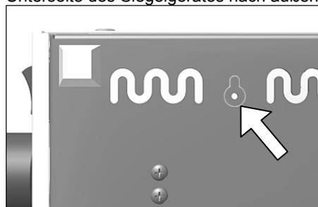
2. Für die Wandaufhängung zwei Bohrungen mit  $\varnothing 6$  mm mit einem Lochabstand von 16,5 cm in der gewünschten Höhe in eine Wand bohren.
