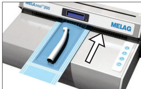
2. Drücken Sie den Hebel nach vorn bis zum Anschlag herunter, bis er einrastet.
