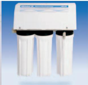
MELAdem®55 ist eine Wasser-Aufbereitungs-Anlage zur Herstellung von hochwertigem demineralisiertem Wasser für die Dampferzeugung im Cliniklav®25. Sie arbeitet nach dem sehr umweltfreundlichen und preiswerten Prinzip der Umkehr-Osmose, deren großer Vorteil darin liegt, dass im Gegensatz zu Ionen-Austauschern keine regelmäßige und die Umwelt belastende Regeneration der bei diesem System benötigten Mischbettharz-Patronen erforderlich ist.
