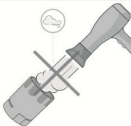
Der korrekte Betrieb der Turbine ist nur dann gewährleistet, wenn sie „sauber“ und frei von Fremdkörpern ist, die ihre Bewegung stören. Vorhandener Staub oder Fremdkörper (wie Haare oder Auswurf usw.) können die beweglichen Teile der Turbine bremsen oder blockieren und die Genauigkeit des Ergebnisses beeinträchtigen oder die Turbine beschädigen.
