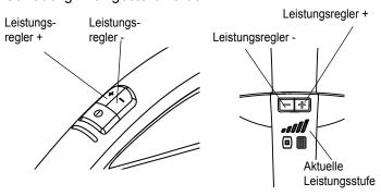
Die aktuelle Leistungsstufe wird am Tragegriff der Superior/ Comfort Modelle angezeigt
