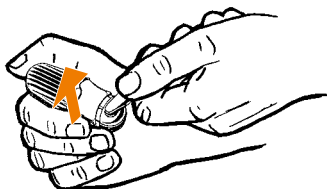
Estrazione del Boccaglio dal Coperchio dell'Unità di Raffreddamento
